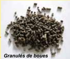
Granulés de boues
